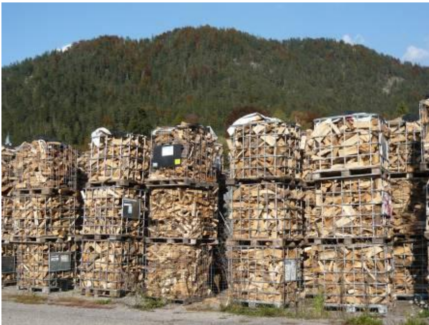
Prirodno sušenje cjepanica u rešetkastim paletama – ovisno o vrsti drva i vremenskim uvjetima, vrijeme skladištenja je 1-2 godine
